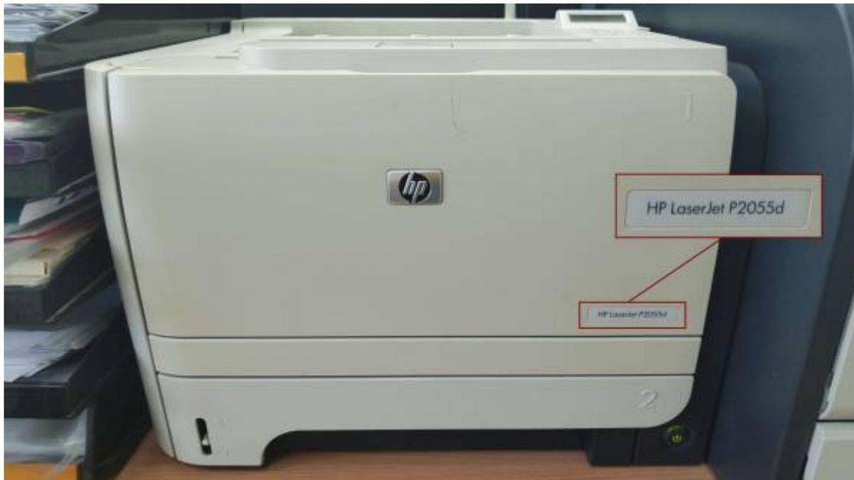
Либо присутствует на заводском шилде, который расположен на тыльной или боковой части принтера или МФУ:
